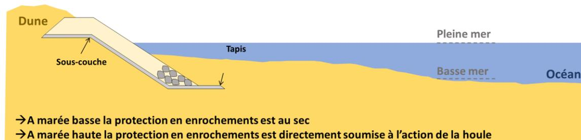
Figure 16. Schéma illustrant une coupe type sur un perré en enrochements
