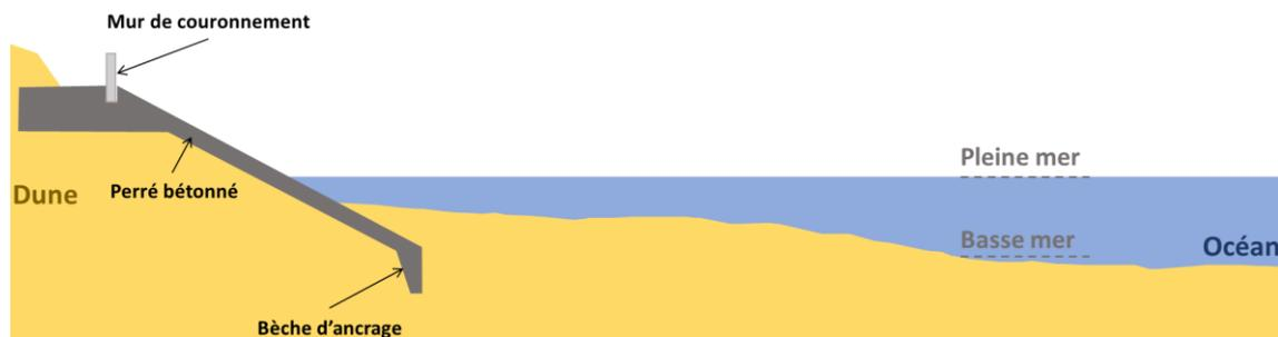
Figure 23. Schéma illustrant une coupe type sur un perré en béton
