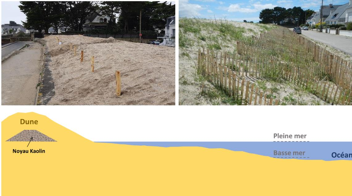
Figure 26. Photographies et coupe type schématique d'une solution noyau kaolin
